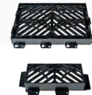
**Opcional:** Para ajustar la medida al ancho de calzada, en los extremos puede acoplarse opcionalmente el módulo 5153 (dimensiones ancho 500 mm y longitud 250 mm). Clase C-250, monobloque y no articulado. Anclajes autoenclavables, para potenciar el agarre del marco en el pavimento.
