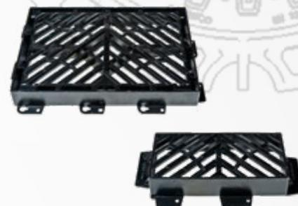
Ensemble grille + cadre D400. Largeur 504 mm, longueur 704 mm. Articulée avec ouverture jusqu'à 110° avec blocage de sécurité pour éviter la fermeture accidentelle. La grille reste encastrée pour éviter les mouvements et le bruit lors de la circulation. Destinée aux chaussées sujettes aux grandes averses, grande capacité d'absorption. Conception des barreaux avec pente inversée pour faciliter l'absorption. Ouverture facile avec les outils communs de chantier.
